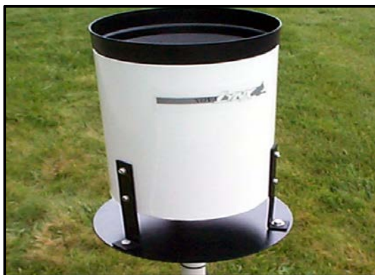
شکل ۲-۸- نمای بیرونی یک باران سنج ایستگاه خودکار
